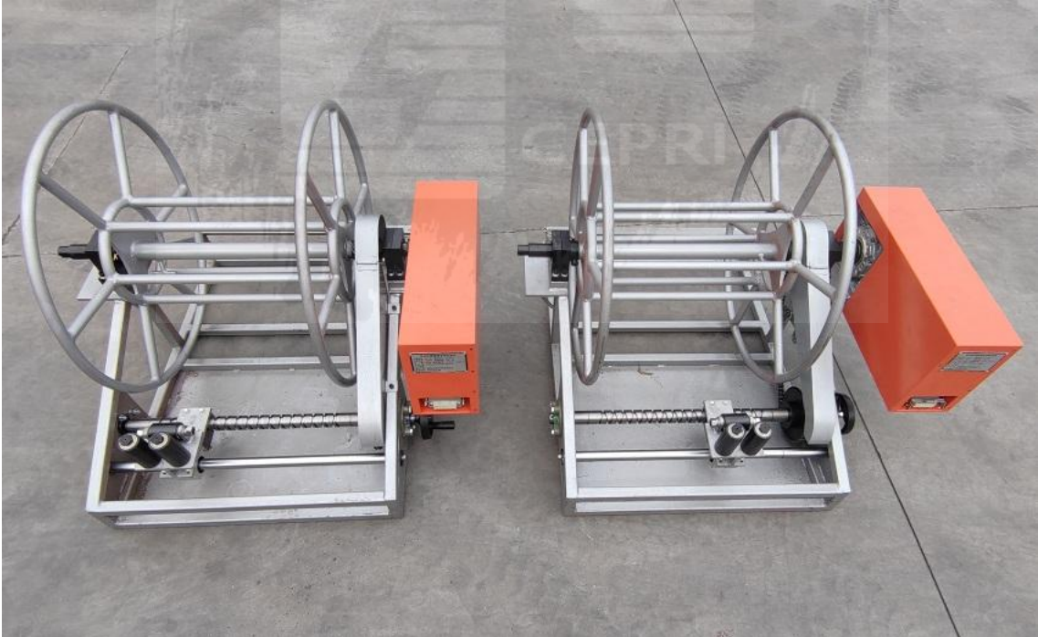
样品照片 4 (电动尾绳自动收放装置)
